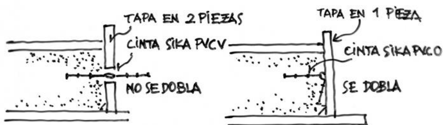
Esquema de junta de retracción de hormigonado de muro in situ con cinta de PVC central
